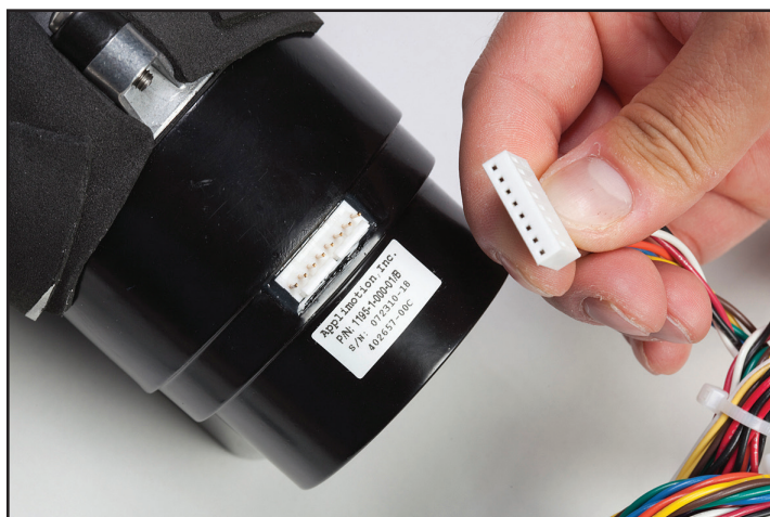
Fig. 8-32 Illustration av pumpanslutningen innan den kopplas in (ovan), ansluten men sitter fel med ett stift exponerat (nedan till vänster) och sitter korrekt (nedan till höger)
