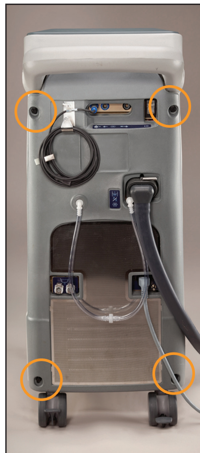
Fig. 8-10 Bakpanel med bultar som ska tas bort (steg 2, vänster)
