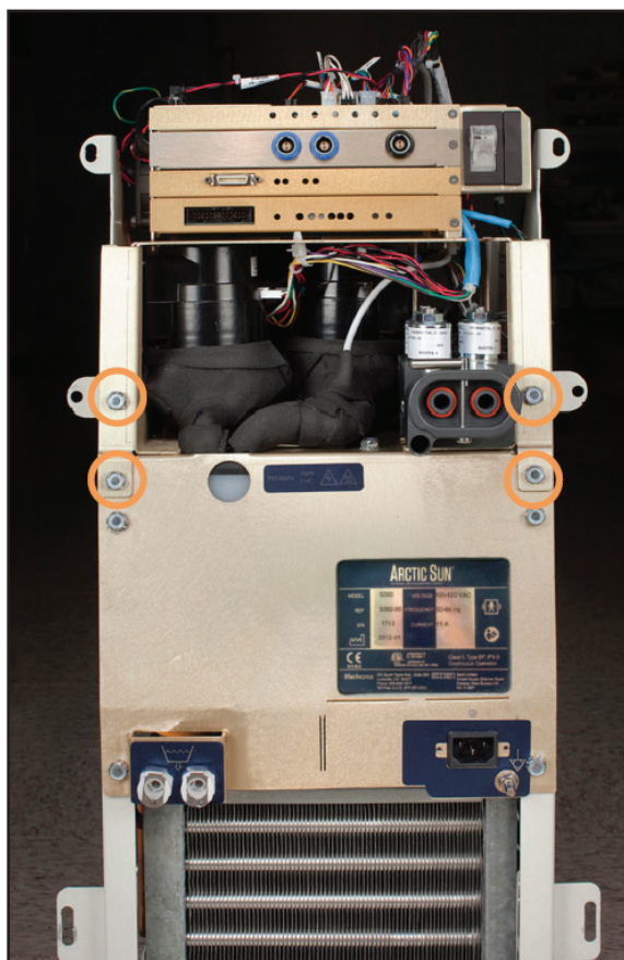
Fig. 8-16 Ta bort fyra bultar (steg 1)
