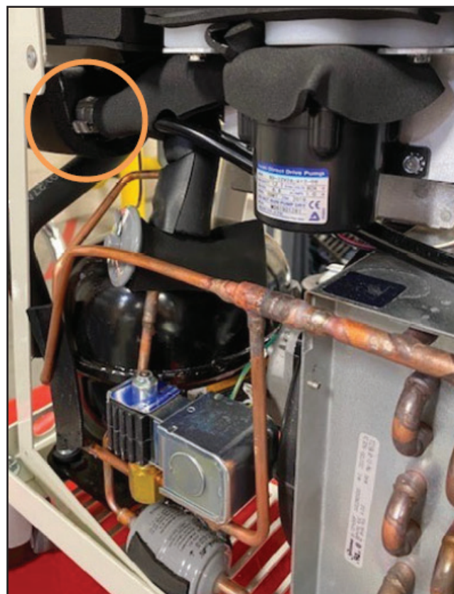
Fig. 8-22 Koppla loss två klämmor (steg 3 – DC-pump)
