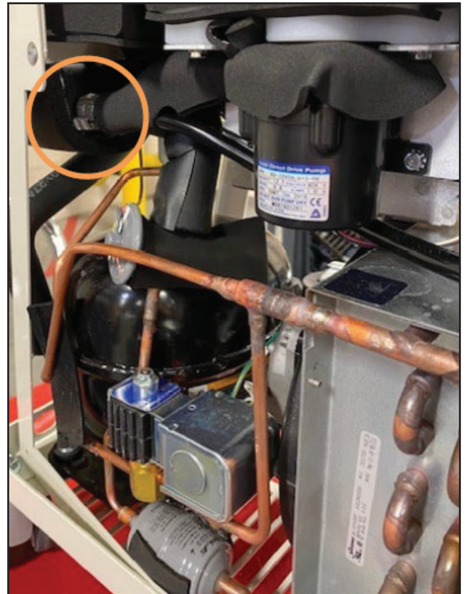
Fig. 8-22 Afmonter to klemmer (trin 3 - jævnstrømspumpe)
