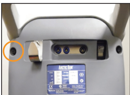
Fig. 8-72 Fjern bolten (trin 1)
