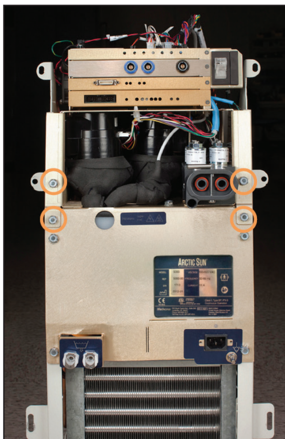
Fig. 8-16 Fjern fire bolte (trin 1)
