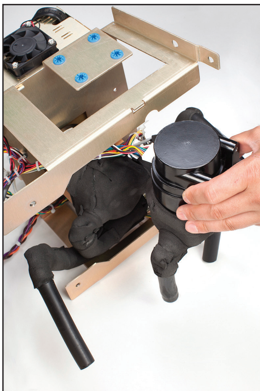
Fig. 8-31 Tag forsigtigt blandepumpen ud (trin 5)
