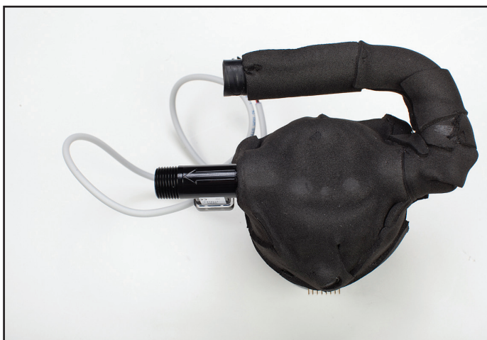
Fig. 8-53 Flowmeter med pil, der viser flowretningen. Samme retning som cirkulationspumpens udgang
