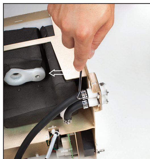
Fig. 8-43 Åbn klemmen, der forbinder kølepumpens slanger med drænventilen
