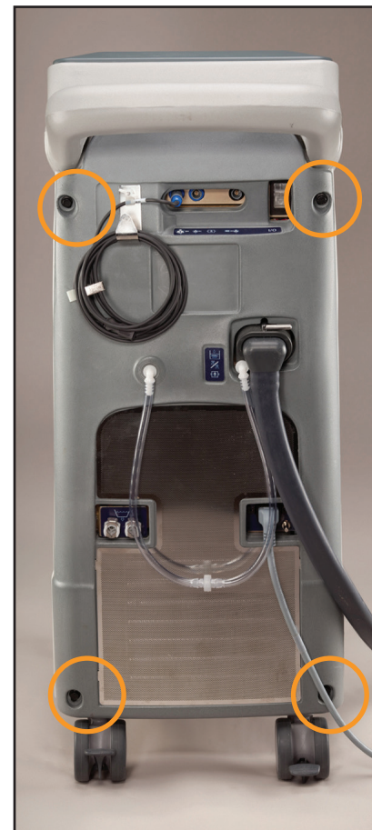
Fig. 8-10 Bagpanel, som viser boltene, der skal fjernes (trin 2, til venstre)
