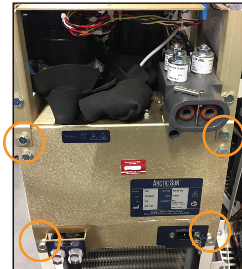
Fig. 8-36 Fjern seks bolte (trin 3)
